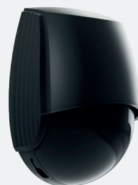
3D Laserscanner Scanprotect nach dem Prinzip der Lichtlaufmessung arbeitender Sensor, überwacht das Feld mit sieben schräg angeordneten Laserstrahlen, individuelle Auswertungsmöglichkeiten, besonders für den Außeneinsatz geeignet, IP 65, Montage bis max. -30 °C
