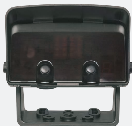
Radarbewegungsmelder MWD-C schnelle, gezielte automatische Toröffnung, richtungserkennend, max. Montagehöhe 7 m, Montage im Tiefkühlbereich bis max. - 22 °C, IP 65
