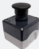
Funkpilztaster kein Verdrahtungsaufwand dank kabellosem Funkzugschalter funk- tionsfähig ohne Batterie, IP 66
